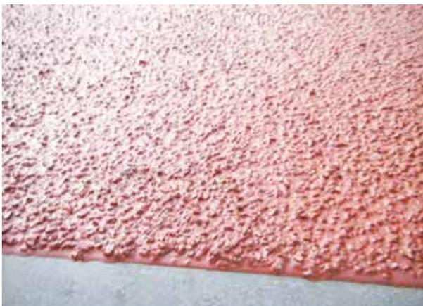
端部10cmの溶接しろにより隣接鉄板の溶接も可能
