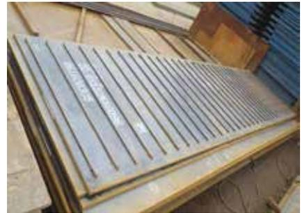
16mmの角鋼を18cm間隔で配置しており、傾斜を伴う路面でもすべりづらく、作業性をあげると共に、トラックの車輪に対しても、最上の摩擦抵抗を発揮します。
