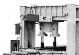
敷鉄板曲がり矯正プレス
